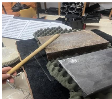
Ilustración 14: Punto de golpe en la viga
